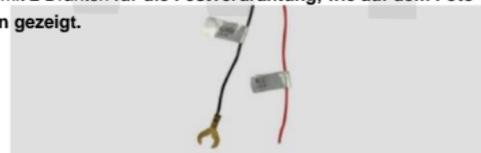
Das **ROTE** Kabel mit der Markierung **B+**, das mit einer Dauersicherung verbunden ist, kann dazu führen, dass diese auch bei ausgeschaltetem Fahrzeug eingeschaltet bleibt. **SCHWARZES** Kabel gekennzeichnete **GND**, die mit einer Metallschraube oder einem Bolzen verbunden ist, kann einen Stromschlag verhindern,
