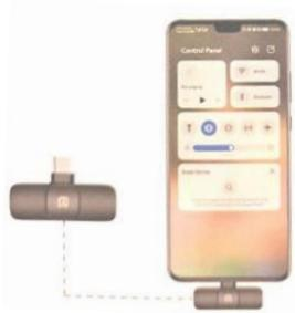
2. Drücken Sie die Ein-/Aus-Taste am Mikrofon für 1 Sekunde, grün. Die LED leuchtet – das Gerät ist dann erfolgreich verbunden.
