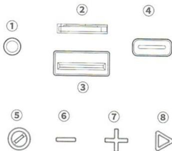
1. AUX-Line-Steckplatz: Mini-3,5-Stecker-Eingang kann mit externem Gerät verwendet werden.
