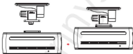
3. Entfernen Sie die Schutzfolie von der Rückseite der Halterung und befestigen Sie die Klebefläche der Halterung an der Windschutzscheibe, wo sie eine ungehinderte Sicht auf die Straße bietet, aber die Sicht des Fahrers nicht beeinträchtigt. Wie unten gezeigt.
