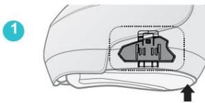
1. Befestigen Sie die Basis an geeigneter Position auf der linken Seite des Helms.
