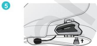
5. Stecken Sie den USB-Stecker in den USB-Anschluss des Bluetooth-Hosts.
