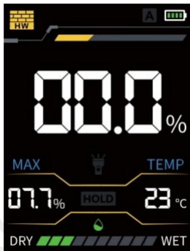
Testmodus für Betonwände
