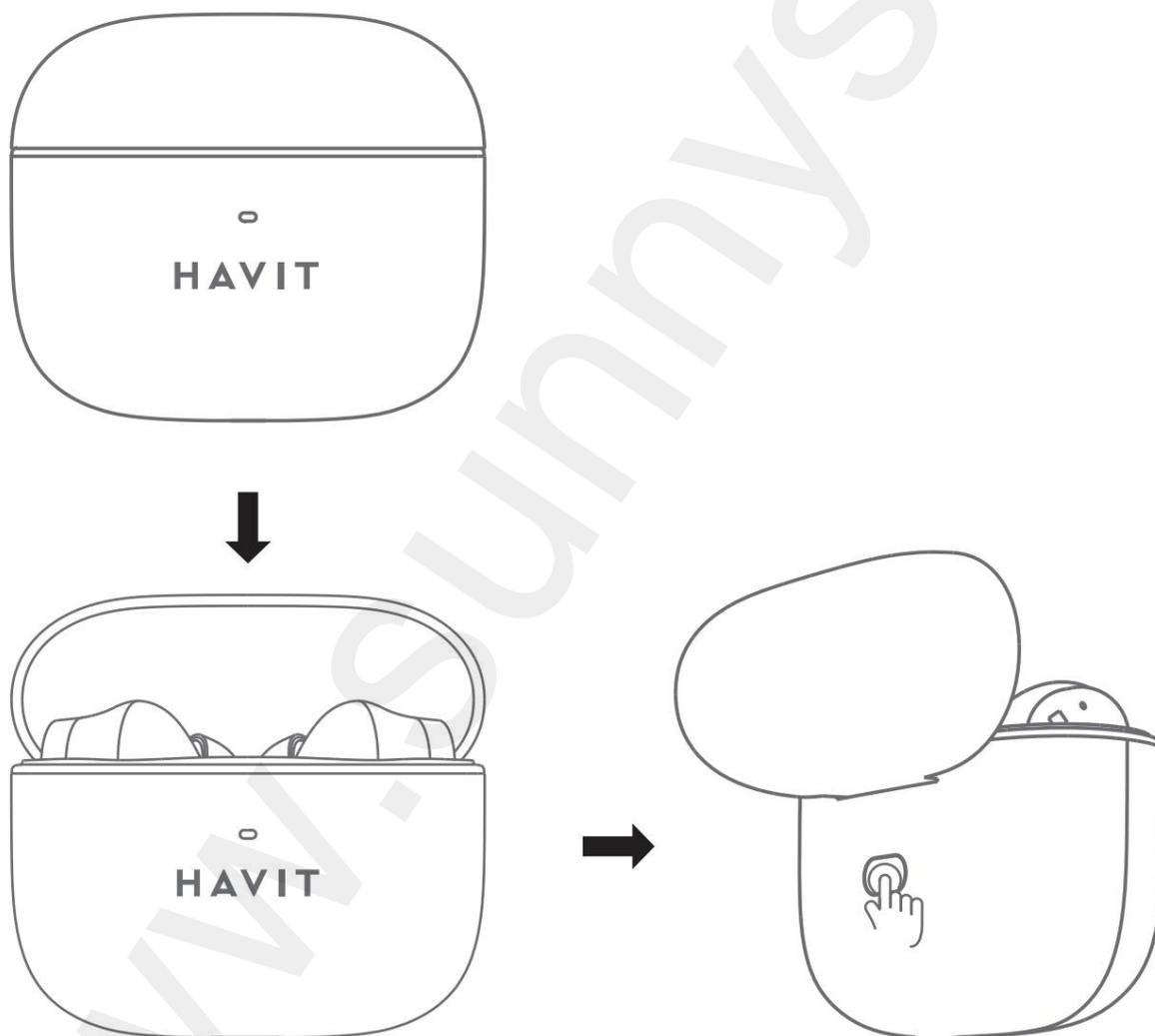
**Öffnen Sie** das Etui und halten Sie die Ohrhörer 10 Sekunden lang gedrückt
