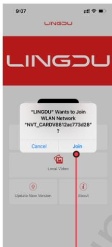
**2** Wenn Sie die LINGDU-App öffnen und Bluetooth auf Ihrem Smartphone aktiviert ist, werden Sie aufgefordert, sich mit dem WLAN-Netzwerk des AM100 zu verbinden. Klicken Sie bitte auf „Verbinden“. Nach etwa 10 Sekunden sind Sie erfolgreich mit dem WLAN des Rekorders verbunden. Alternativ können Sie auch in den Einstellungen Ihres Smartphones unter „WLAN“ das WLAN des Dashcams auswählen.
