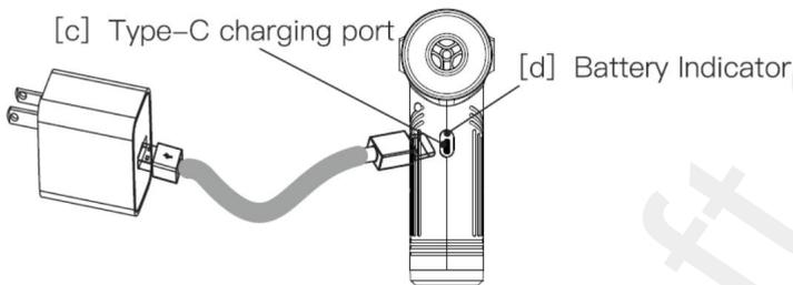
Verbinden Sie Adapter und Gerät mit dem Kabel [c] wie in der Abbildung oben gezeigt: Stecken Sie das Typ-C-Ende in den Anschluss unter der Akkuanzeige [d].
