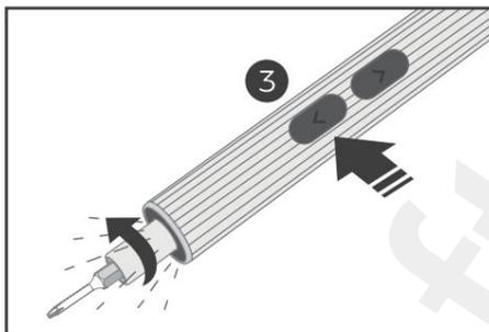
2. Drücken Sie **die Taste 3**, ziehen Sie die Schraube fest und Mach das Licht an.
