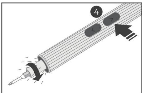
3. Drücken Sie **die Taste 4**, lösen Sie die Schrauben und schalten Sie gleichzeitig ein Licht.
