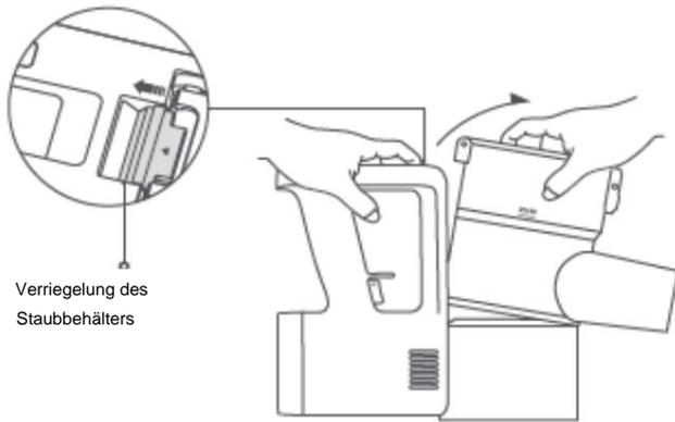
2. Entfernen Sie den Vorfilter, heben Sie den Griff an und drehen Sie ihn gegen den Uhrzeigersinn, um den Filter zu entfernen.
