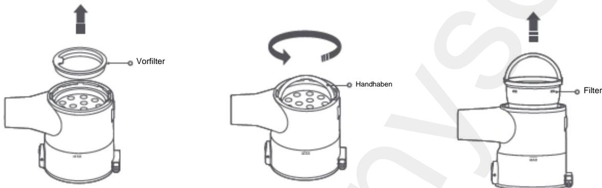
3. Entfernen Sie den hinteren Filter, indem Sie ihn gegen den Uhrzeigersinn drehen.
