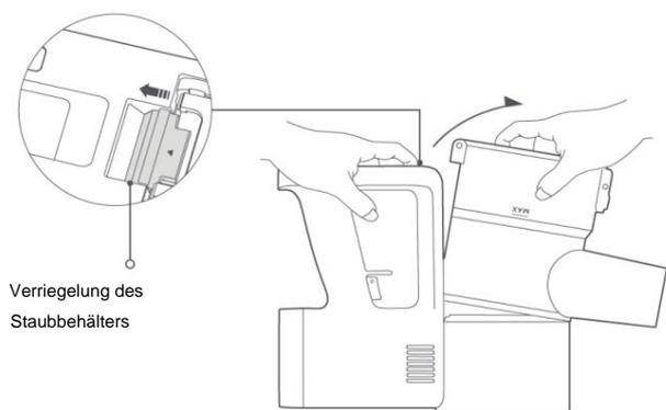
2. Entfernen Sie den Vorfilter, heben Sie den Griff an und drehen Sie ihn gegen den Uhrzeigersinn, um den Filter zu entfernen.
