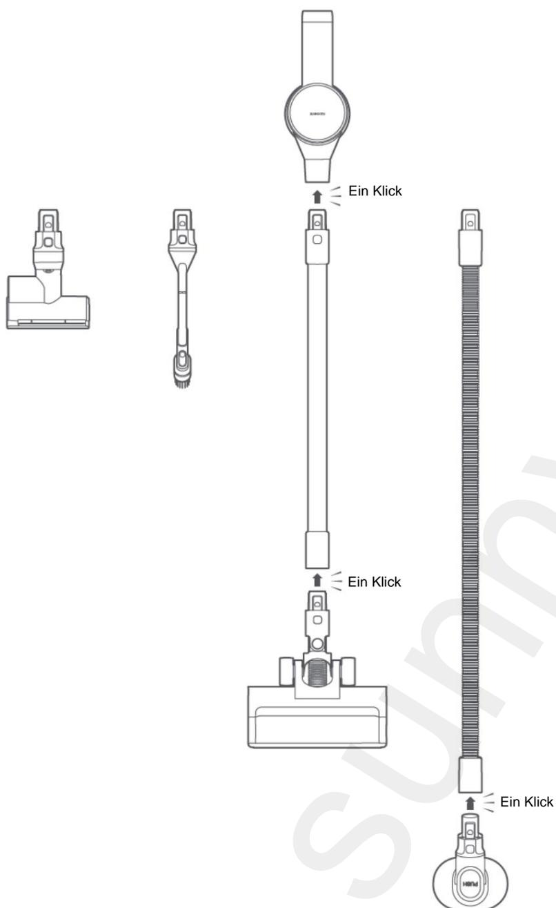
Hinweis: Verwenden Sie den Verlängerungsschlauch nicht mit einer Elektrobürste oder Mini-Elektrobürste.
