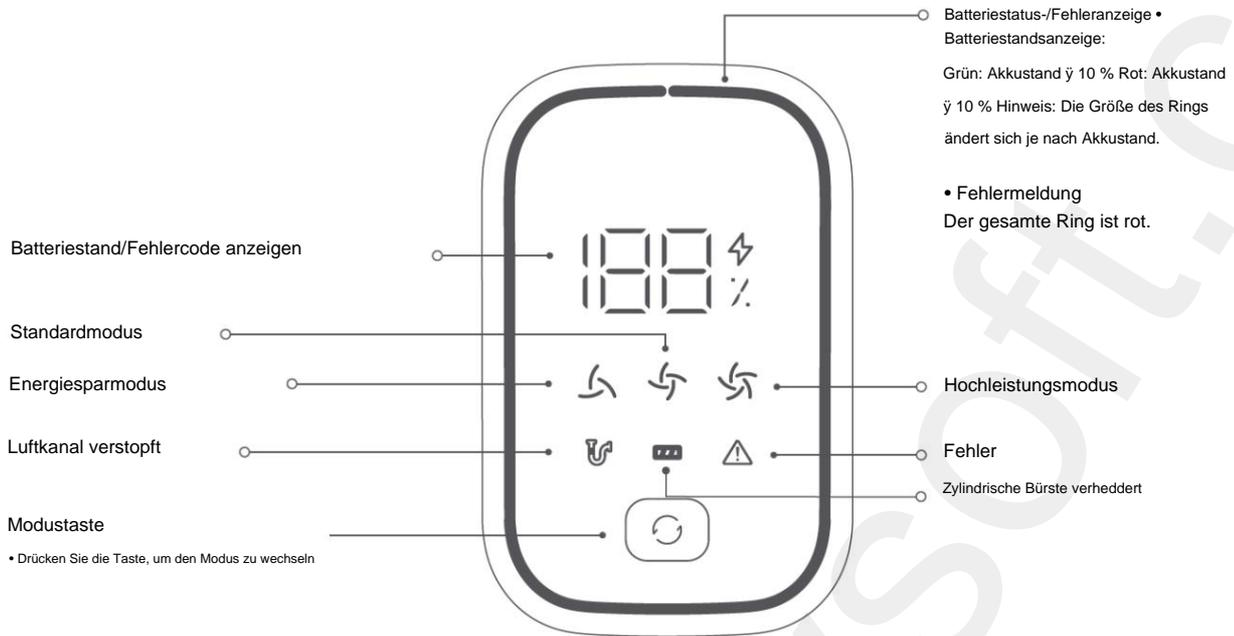
Hinweis: Sollte der Staubsauger nicht ordnungsgemäß funktionieren, erscheinen entsprechende Fehlermeldungen auf dem Display. Eine Lösung finden Sie im Abschnitt Fehlerbehebung. Wenn das Problem weiterhin besteht, wenden Sie sich an den Kundendienst.
