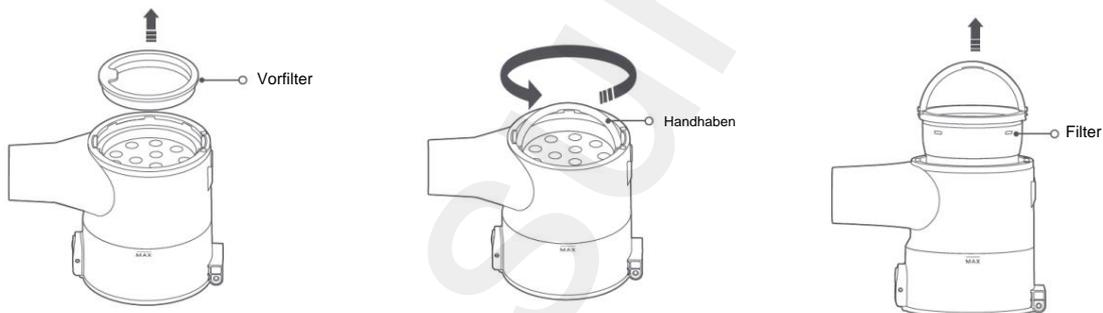
3. Entfernen Sie den hinteren Filter, indem Sie ihn gegen den Uhrzeigersinn drehen.
