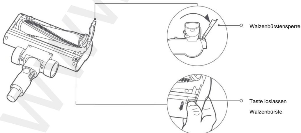
2. Wischen Sie Staub und Schmutz mit einem trockenen Tuch oder Papiertuch von der Saugöffnung und der transparenten Abdeckung.
