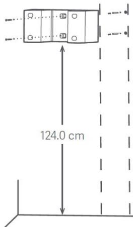
Montage der Wandhalterung des Staubsaugers
