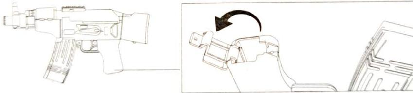
1. Öffnen Sie das Batteriefach (an der Unterseite des Geräts) und nehmen Sie die Lithiumbatterie heraus.
