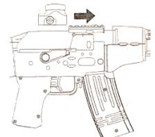
2. Bringen Sie das Verbindungsstück in die richtige Position und befestigen Sie es mit der Schraube.
